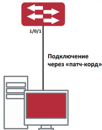
Рисунок 5. Управление коммутатором по Telnet
