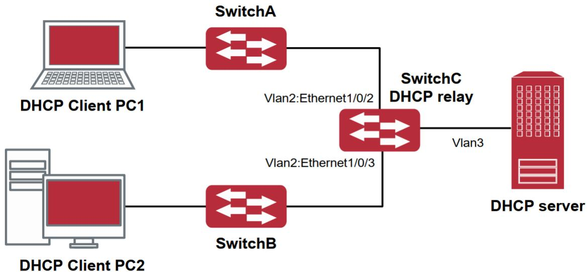
Рисунок 62. Типовой пример применения опции 82 DHCP
