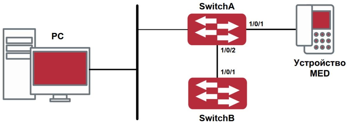
Рисунок 26. Топология базовой конфигурации LLDP-MED
