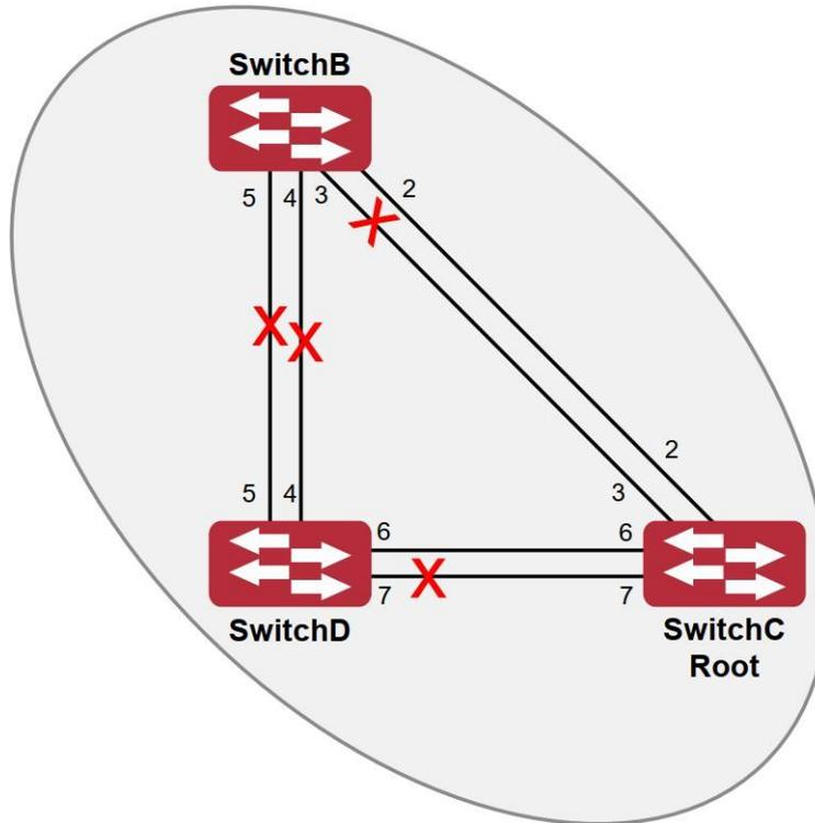
Рисунок 44. Топология экземпляра связующего дерева 3 после вычисления MSTP
