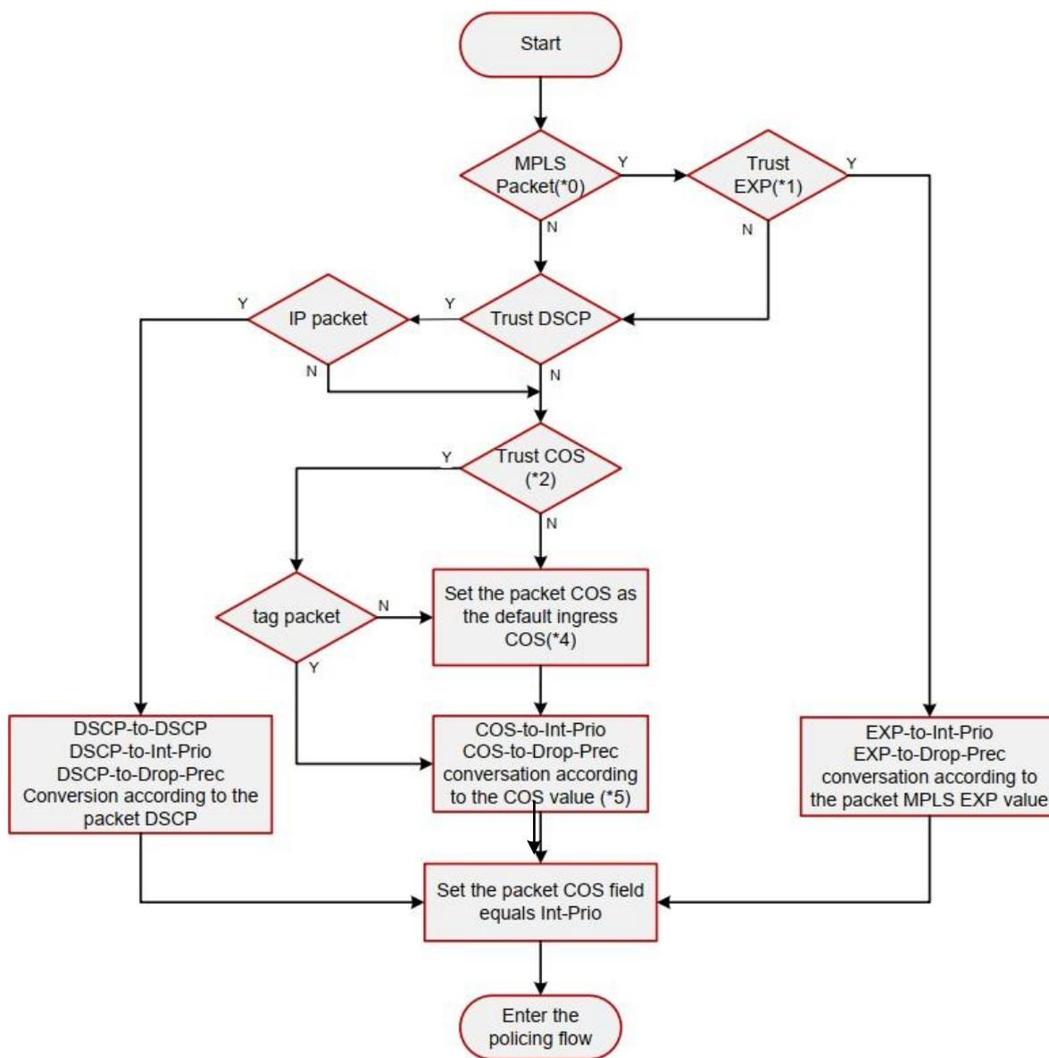
Рисунок 49. Процесс классификации
