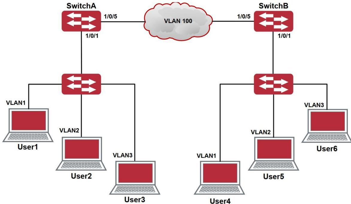
Рисунок 35. Типичное применение трансляции VLAN
