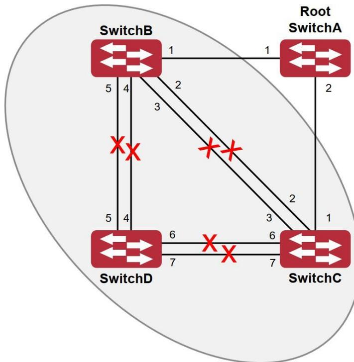
Рисунок 43. Топология экземпляра связующего дерева 0 после вычисления MSTP
