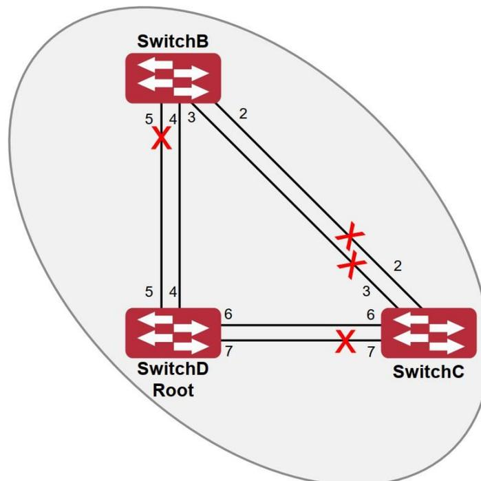
Рисунок 45. Топология экземпляра связующего дерева 4 после вычисления MSTP
