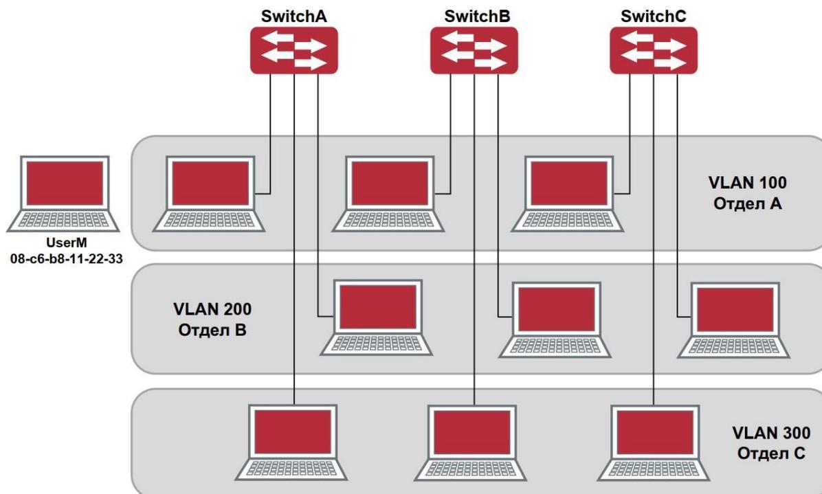
Рисунок 36. Типовая топология применения динамического VLAN'a
