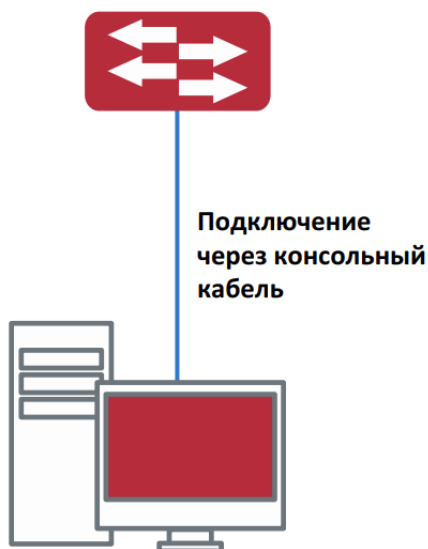
Рисунок 1. Подключение ПК к консольному порту коммутатора
