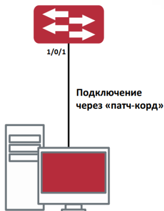
Рисунок 5. Управление коммутатором по Telnet
